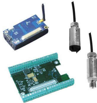
Fig. 1. Nodo Caudal: Mote IRIS, placa de adaptación y sensores
