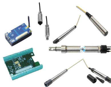
Fig. 2. Nodo Multiparamétrico: Mote IRIS, placa de adaptación y sensores
