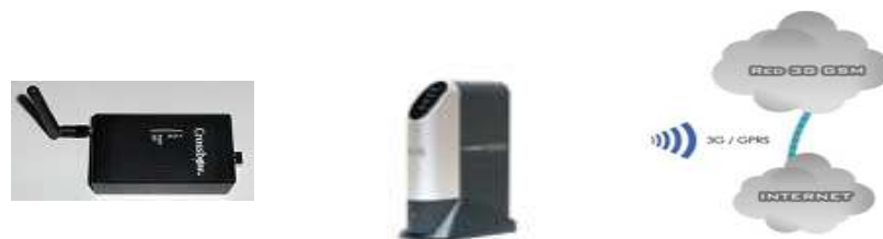
Fig. 3. Nodo Central: estación base, servidor BD y conexión 3G
