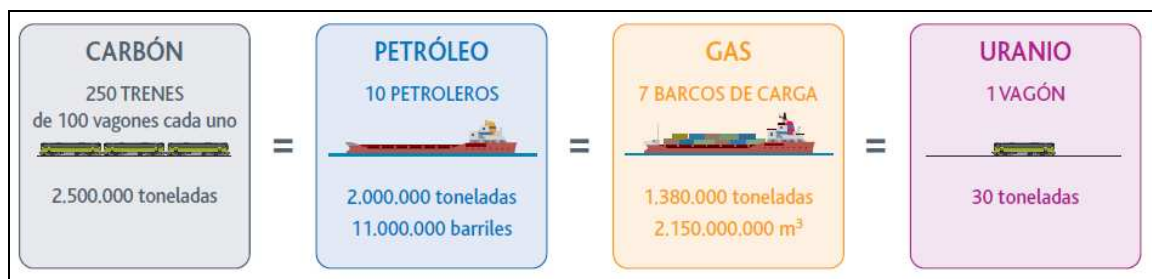
Fig. 6 Necesidades anuales de abastecimiento de combustible para una central tipo de 1000 MWe de potencia instalada. Fuente: elaboración propia
