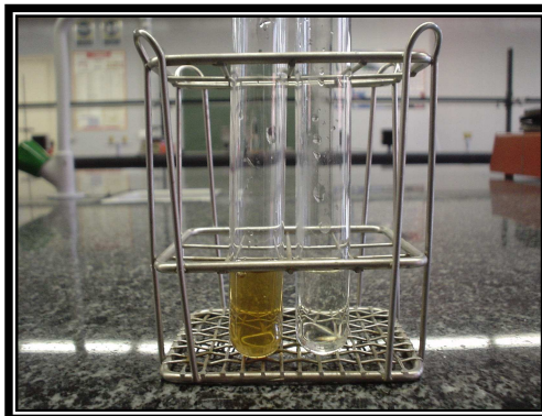
Imagen 1: Muestra de lixiviado decantada (izquierda) y muestra de lixiviado sometida a adsorción con carbón activado en polvo (derecha)
