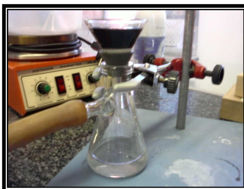
Imagen 2: Lixiviado sin turbidez (muestra tratada con carbón activado en polvo)
