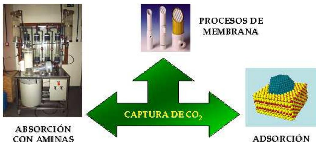
**Figura 2.** Procedimientos de captura de CO<sub>2</sub>.
