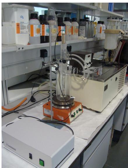
**Figura 6.** Reactor fotocatalítico equipado con sistema interno de radiación UV.
