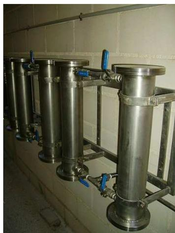
**Figura 5.- Detalle de los cilindros de acero inoxidable del sistema de purificación del aire diseñados por el Grupo de Investigación de Seguridad e Higiene en la Industria de la UMU.**
