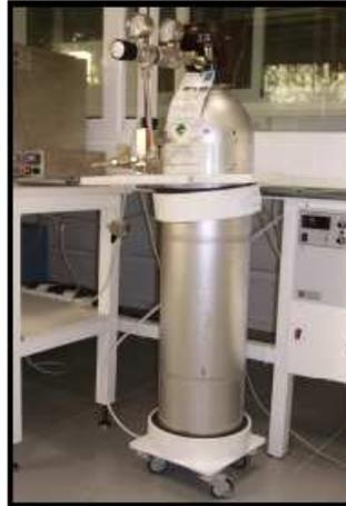
Figura 7.- Botella que contiene el gas de ensayo.
