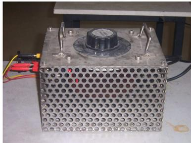
Figura 11.- Transformador de corriente multivariable.
