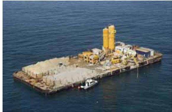
Foto 14: Pontona con planta de hormigonado
