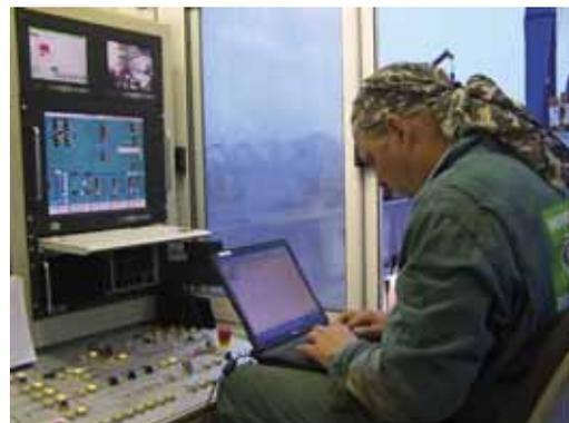
Foto 16: Cabina de guiado de tuneladora
