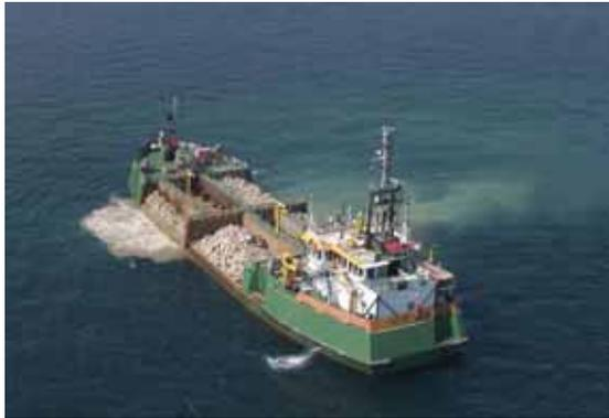
Foto 13: Embarcación de vertido lateral para el aporte de gravas y escolleras de protección del emisario
