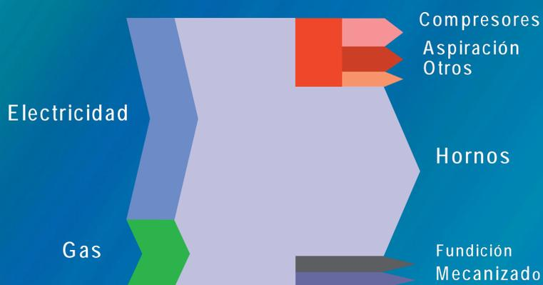
Figura 2. Diagrama de Sankey de la instalación industrial de una fundición
