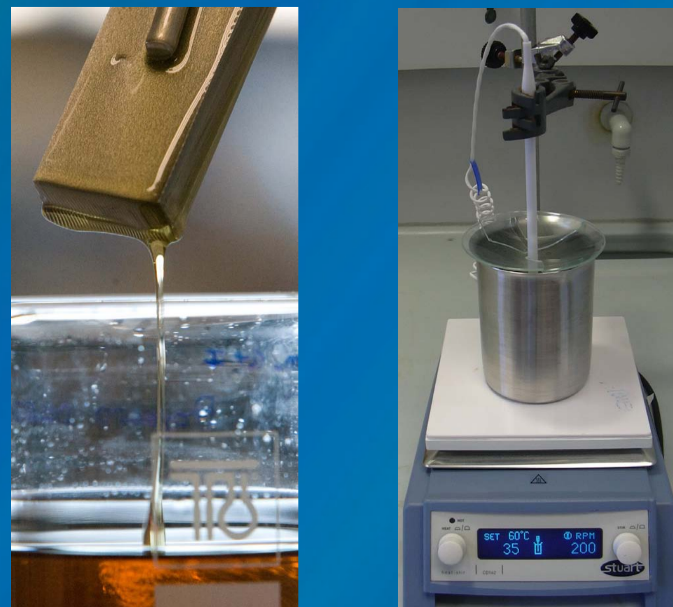
Figura 1: Montaje proceso engrase/desengrase en laboratorio
