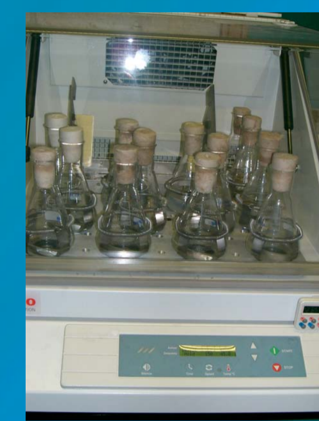
Figura 2: Ensayos de desengrase biológico en laboratorio
