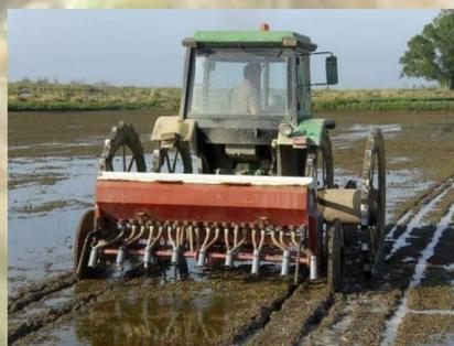
Sembradora en hileras, adaptada de una sembradora de cereal de secano
