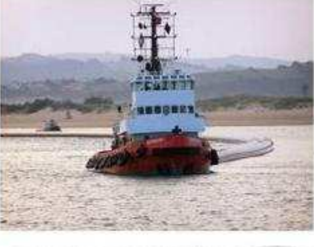
TRANSPORTE DE LA TUBERÍA REMOLCADA DESDE SUECIA HASTA SANTANDER
