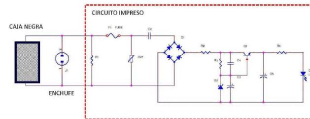
Se trata de un circuito típico de fuente de alimentación, cuyo único propósito es el de encender el diodo led en la parte frontal del equipo. La resistencia R1, cuyo valor es de 500 kohm, se encargaría de descargar cualquier capacidad que hubiese en la “caja negra”.
