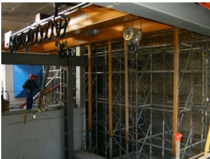
Puente grúa para movimiento de los contenedores (20.000 kgs.)
