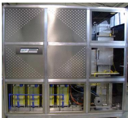
Figura 8.9. Una de las 6 Pilas de Combustible que se instalará
