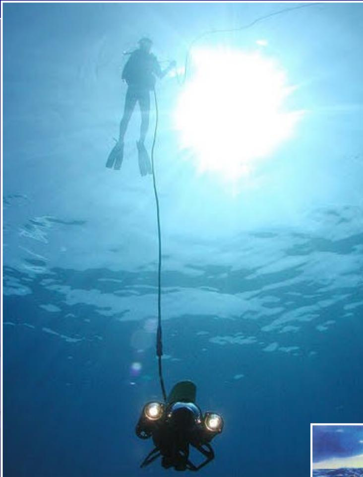
Robots de control remoto para filmaciones submarinas (ROV).
