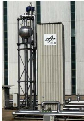
Prototipo de 700 kWh diseñado en el proyecto REALDISS
