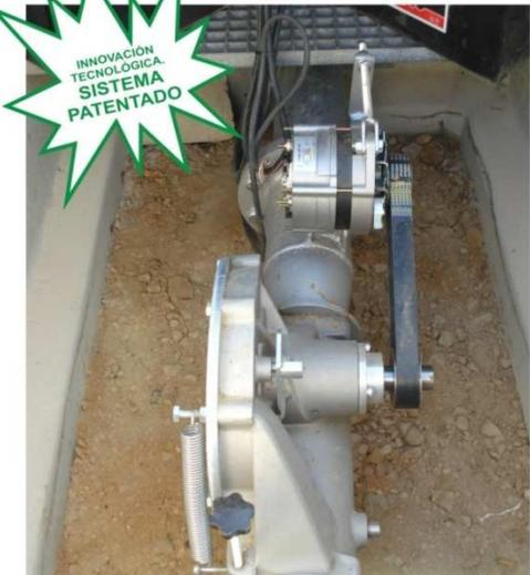
DISPOSITIVO ENERGÉTICO PARA EL ACCIONAMIENTO DE PIVOTS DE RIEGO PAT. INT. PCT/ES/2010/000186
